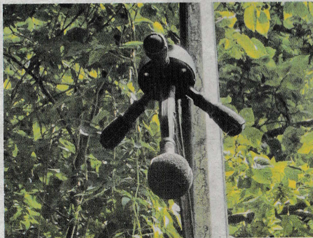
Le radar méduse se compose de capteurs acoustiques et d'une caméra.
